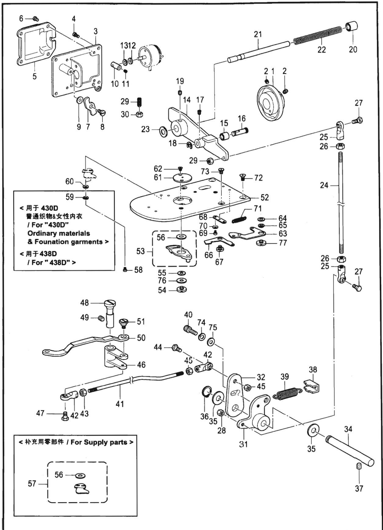
K. 切线装置 / Thread trimmer mechanism
