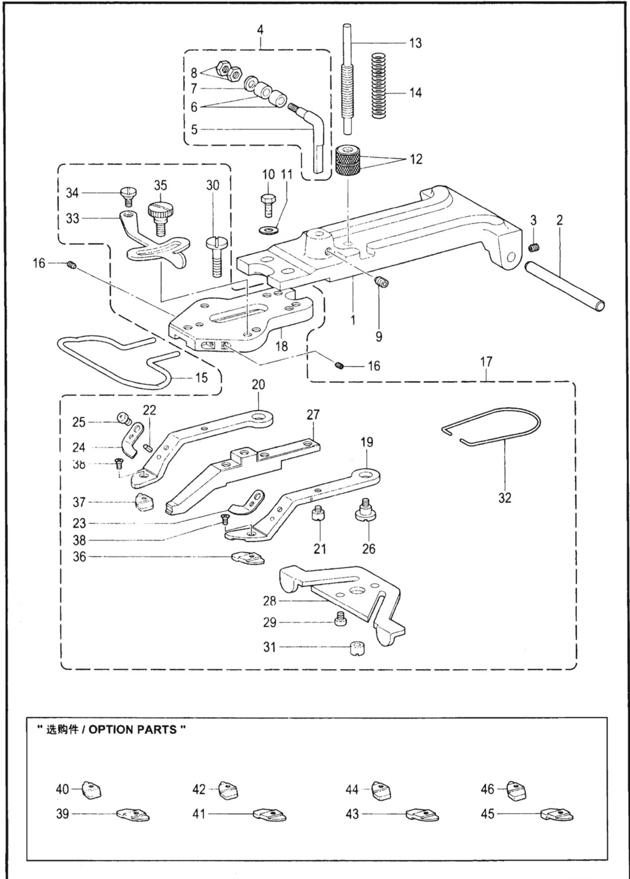
E. 钮夹 · 作动装置 / Button clamp mechanism
