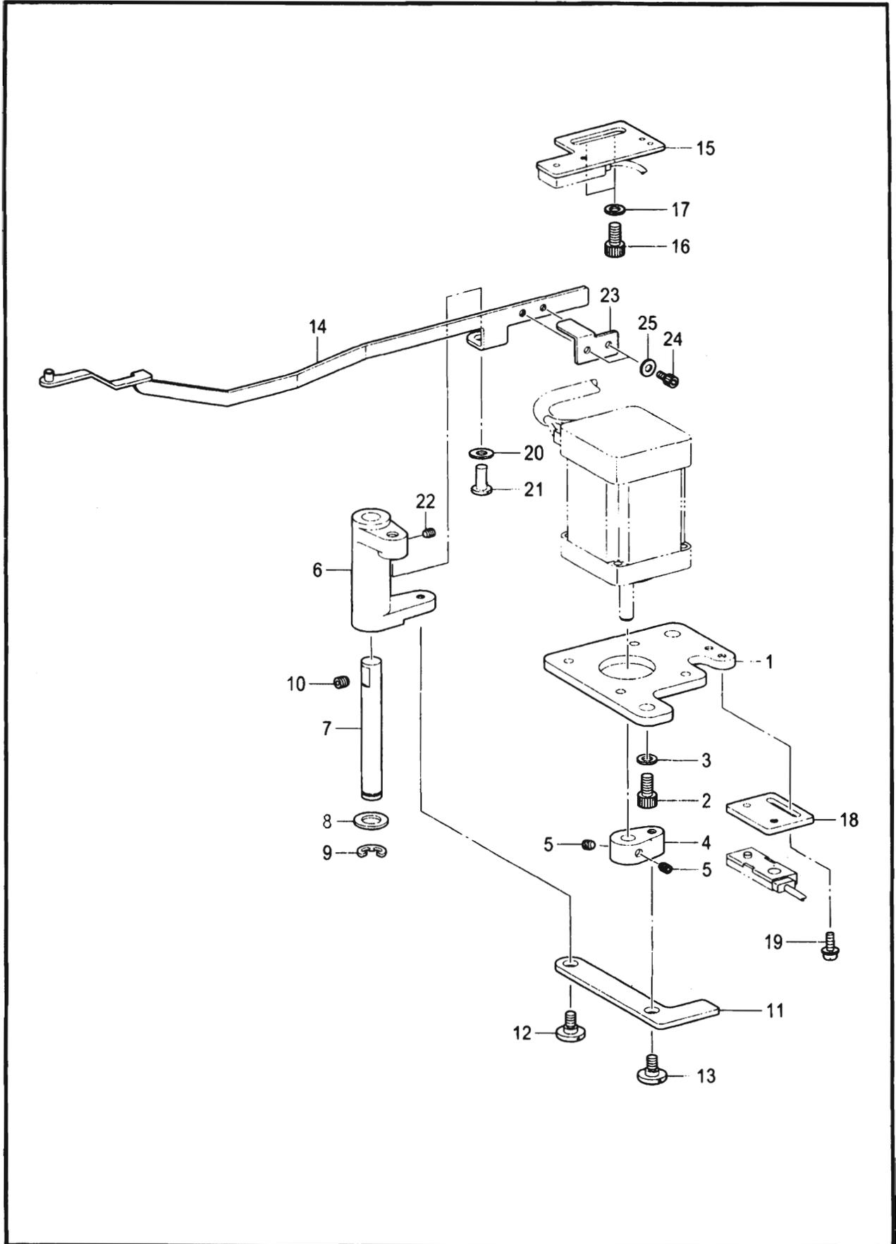
N. 夹线装置 / Thread nipper mechanism
