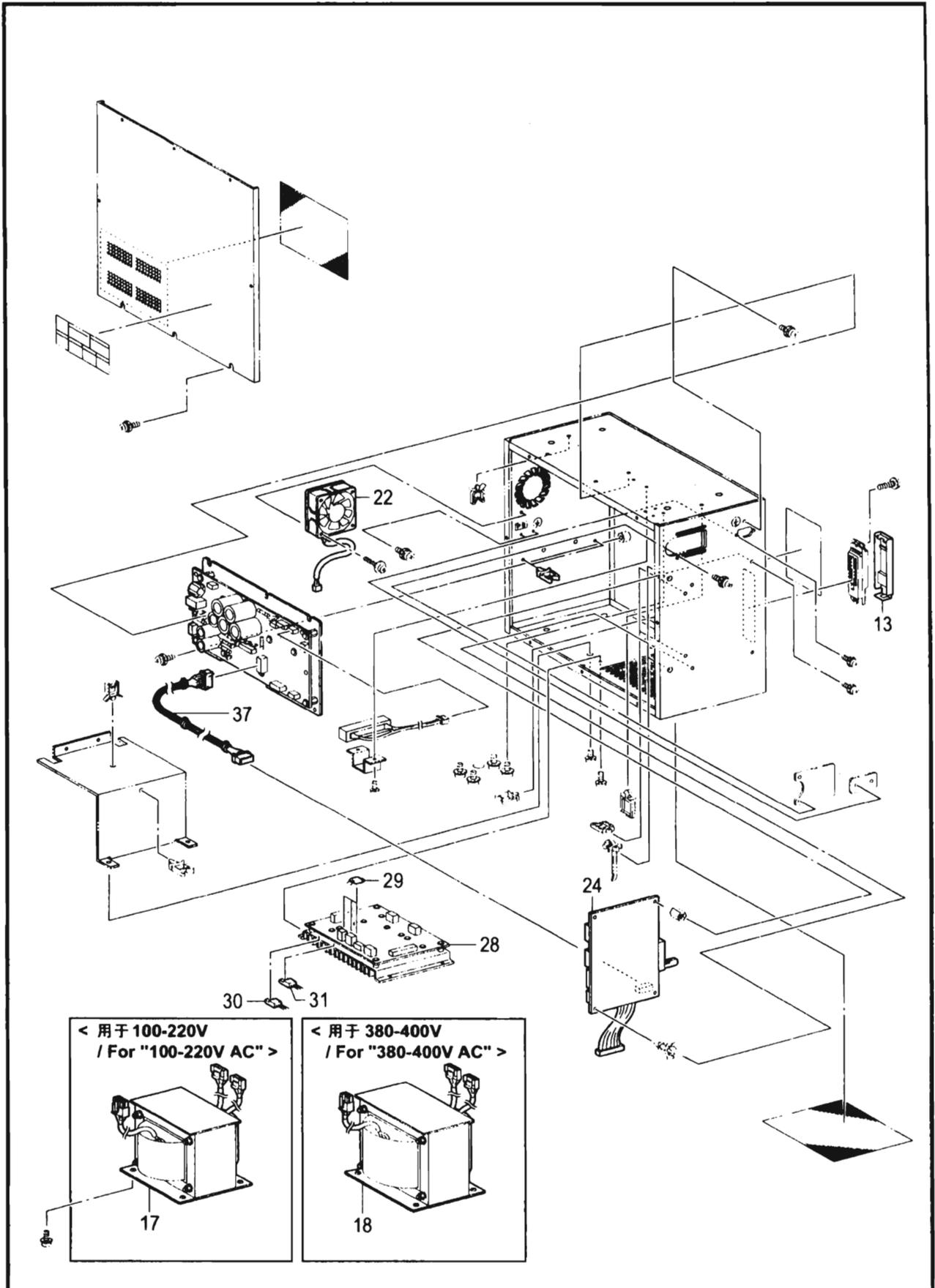
P1. 控制箱装置 / Control box mechanism
