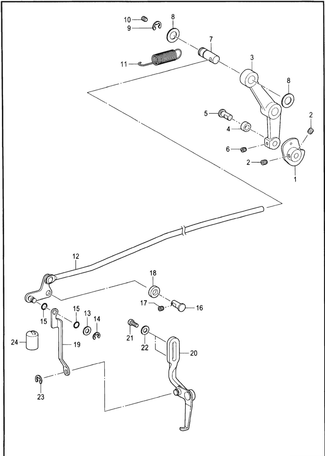
L. 扫线装置 / Thread wiper mechanism
