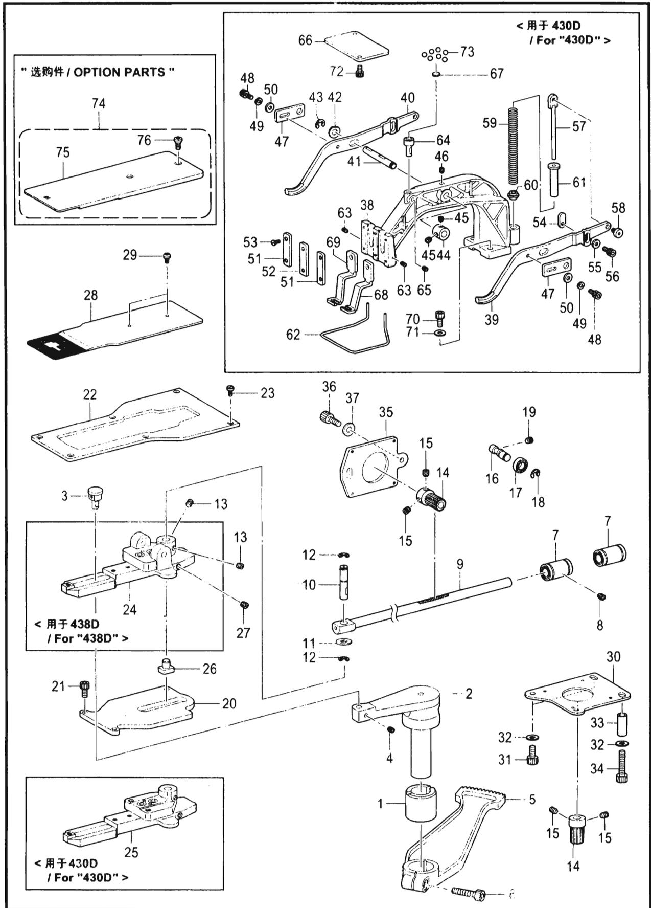
C. 送料装置 / Feed mechanism
