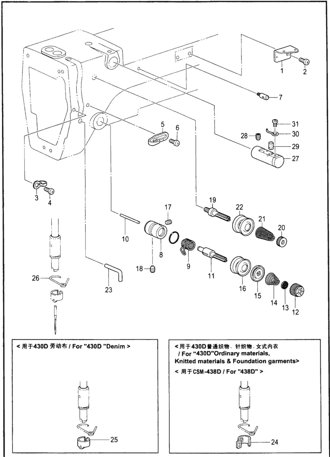
H. 穿线装置 / Threading mechanism
