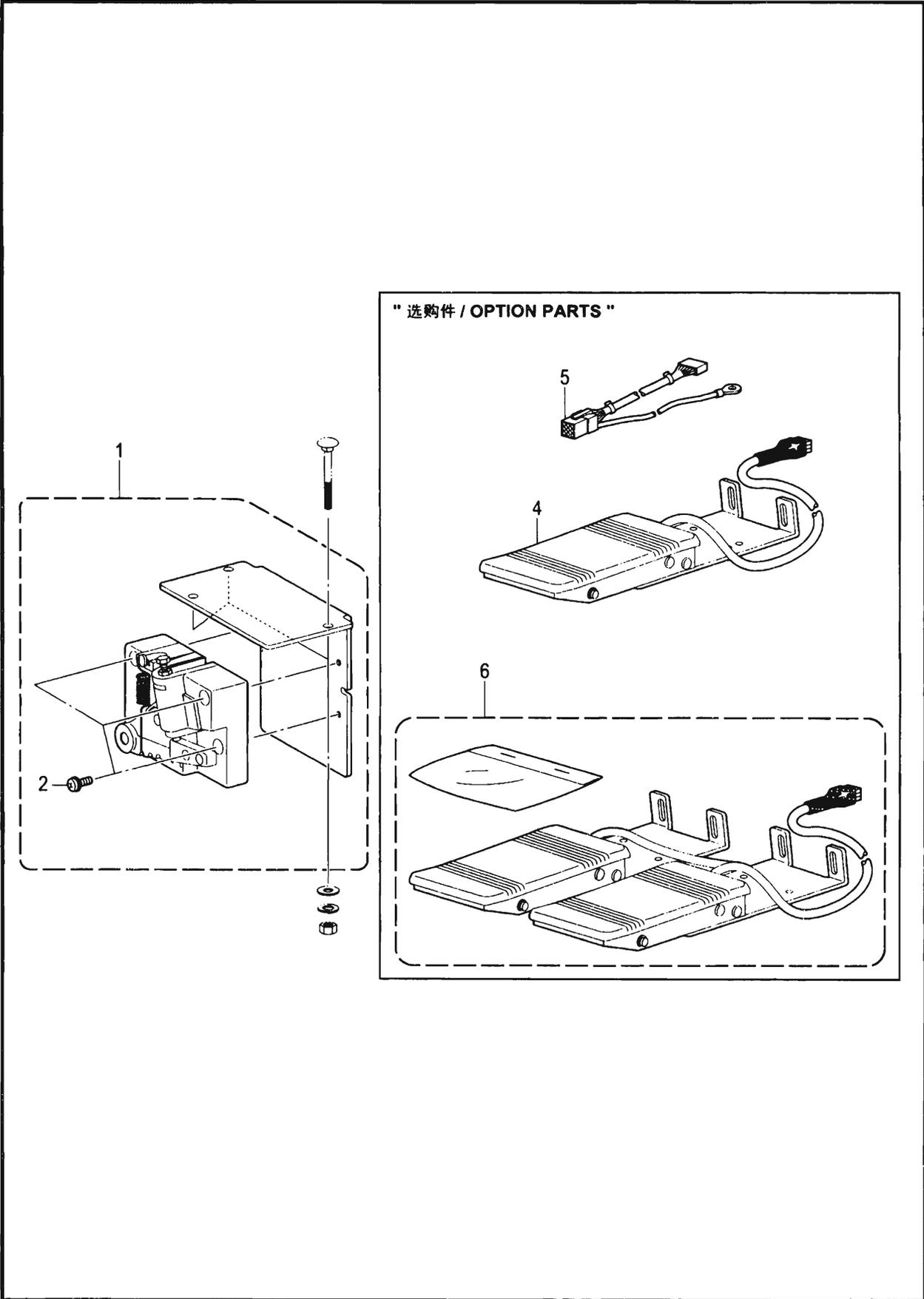
U. 踏板关系 / Foot switch pedal mechanism
