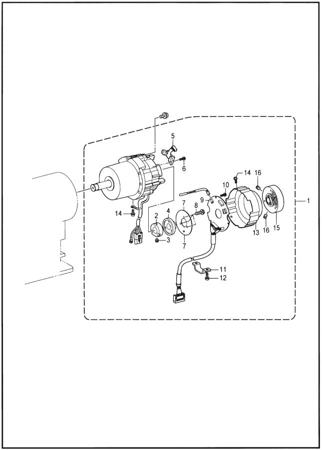
T. 马达装置 / Motor mechanism
