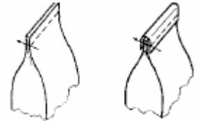
Doblado de la boca efectuado a mano por el operario/a.
